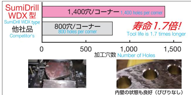
被削材 Work material : ブレート Steel plate (S15C)
